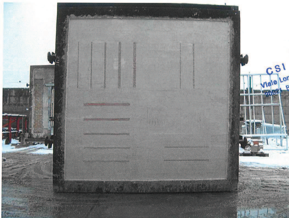
Foto 1. Lato esposto al fuoco del campione prima della prova
